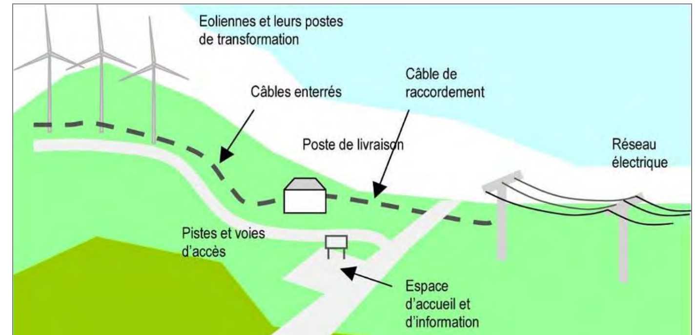
Figure 2 : Schéma de principe d'un parc éolien (Source : Guide de l'étude d'impact sur l'environnement des parcs éoliens, 2010)
